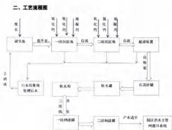
图 3-5 A 区污水处理厂工艺流程图
